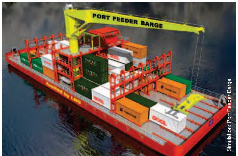
So soll die Barge aussehen: 64 Meter lang, 21 Meter breit, Platz für 168 TEU
