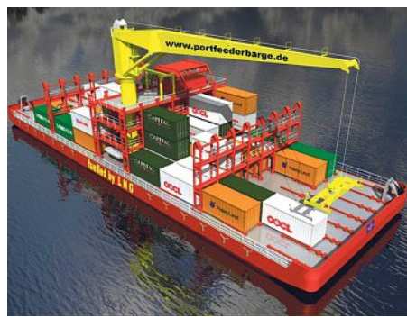
Das neue Transportsystem besteht aus einem selbst fahrenden Containerponton, der mit einem leistungsstarken Kran ausgestattet ist
