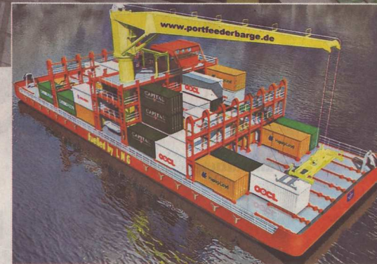
Die Port Feeder Barge soll Container mit eigenem Kran aufnehmen und wegfahren. Sie kann auch Feeder- und Binnenschiffe abfertigen
