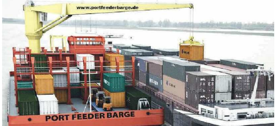
Grafische voorstelling hoe de Port Feeder Barge een binnenschip voor anker belaadt. Illustratie Port Feeder Barge, www.portfeederbarge.de
